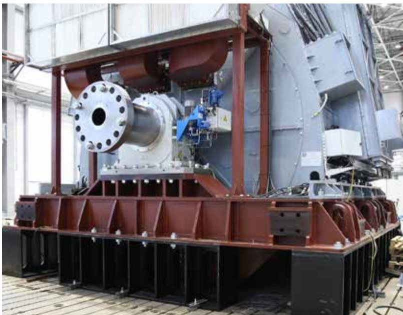
Вентильно-индукторный двигатель. Фото с сайта КГНЦ
